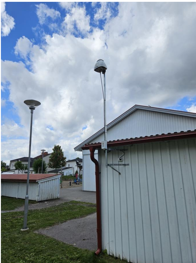
Figur 2. Instrumentet Kunak AIR Pro installerat på ett förråd på förskolegården.
