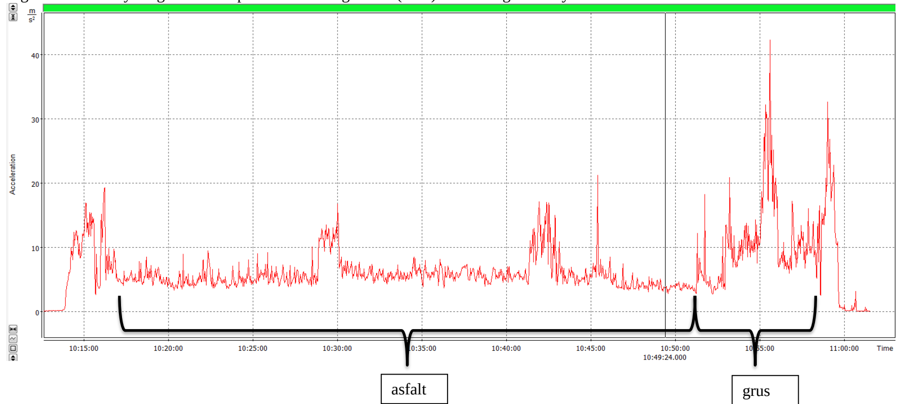
Figur 2. Motionscykling med racer på olika underlag: RMS ( \text{m/s}^2 ) för HAV genom styret över tid.
