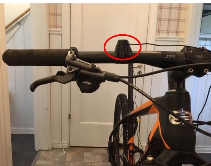
Bild 4. Accelerometer fäst på styret med anslutningskabel till SVANTEK 106.
