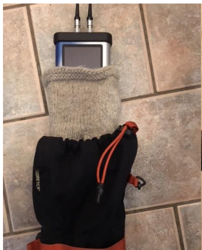
Bild 5 och 6. Fuktsäkring av SVANTEK 106 och accelerometer.
