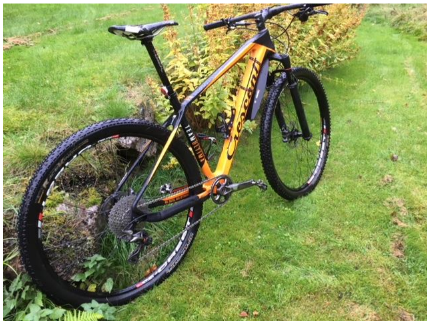
Bild 1. MTB av vanlig typ för motionscykling använd under vibrationsmätningar – 29 tum "hardtail" i storlek M/L (48 cm) med dämpad framgaffel; ram, styre och styrstam av kolfiber; hjul av aluminium, däckbredd 2,25 tum.
