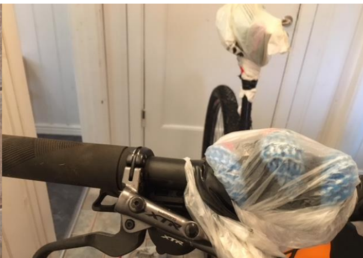
Bild 5 och 6. Fuktsäkring av SVANTEK 106 och accelerometer.
