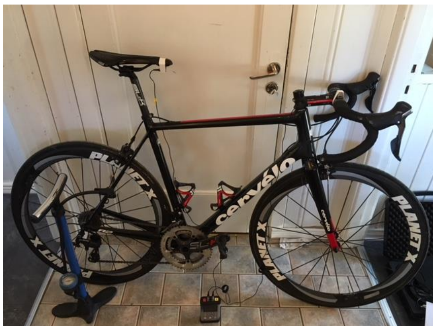
Bild 2. Landsvägsracer använd under vibrationsmätningar. Storlek M/L (56 cm); ram och hjul i kolfiber, styre och styrstam i aluminium; däckbredd 23 mm.
