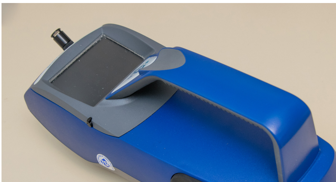
Instrumentet DustTrak 8354 användes vid loggande provtagning av \text{PM}_{2,5} och \text{PM}_{10} .
