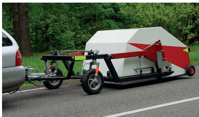
Figur 2. Mätvagn från TUG (Tekniska Universitetet i Gdansk) för mätning med CPX-metoden som använts i detta projekt. Till höger visas mätvagnen med skyddshuven öppen. Foton från [7].
