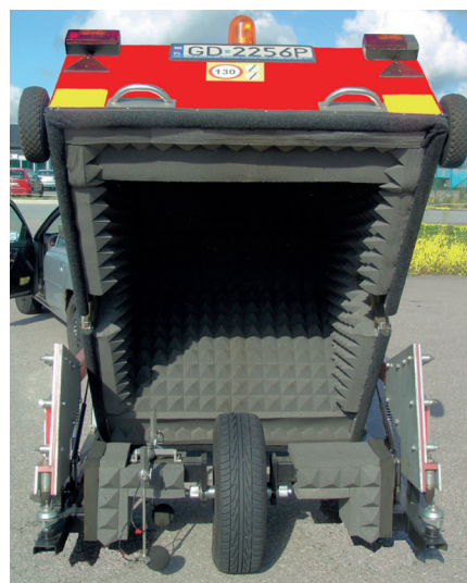
Figur 2. Mätvagn från TUG (Tekniska Universitetet i Gdansk) för mätning med CPX-metoden som använts i detta projekt. Till höger visas mätvagnen med skyddshuven öppen. Foton från [7].
