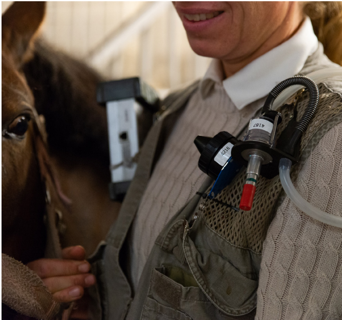
Figur 7. Ridinstruktör med provtagningsutrustning för inhalerbart damm samt respirabelt damm och kvarts. Direktvisande instrument, DataRam, mätte även variationen av damm över dagen.
