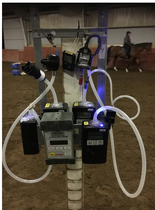
Figur 6. Stationär provtagningsutrustning för bland annat mätning av inhalerbart damm samt respirabelt damm och kvarts. Direktvisande instrument, DataRam, mätte även variationen av damm över dagen.
